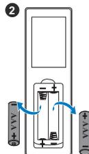
3 Insira as pilhas e alinhe sua polaridade corretamente de acordo com a marcação no compartimento de pilhas.
