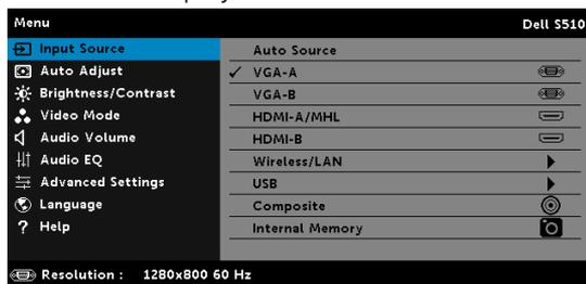
**VGA-A**—Pressione para detectar um sinal VGA-A.
