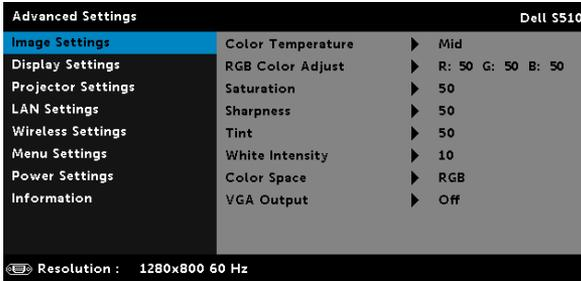
**COLOR TEMPERATURE (TEMPERATURA DA COR)**—Permite ajustar a temperatura da cor. A tela parece mais fria a temperaturas de cor mais altas, e mais quente a temperaturas de cor mais baixas. Ao ajustar os valores no menu **Color Adjust (Ajuste de cor)**, o modo Personalizado é ativado. Os valores são salvos no Custom mode (modo Personalizado).
