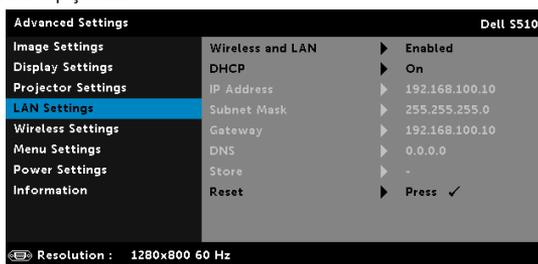
**WIRELESS AND LAN (SEM FIO E LAN)**—Selecione **Enabled (Habilitar)** para ativar a função Wireless and LAN (Wireless e LAN). Selecione **Disabled (Desabilitado)** para desativar a função Wireless and LAN (Wireless e LAN).
