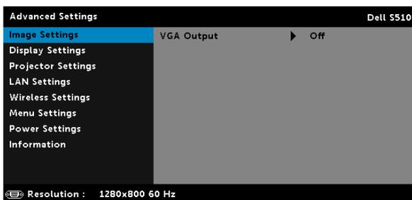
**VGA OUTPUT (SAÍDA VGA)**—Selecione On (Ligado) ou Off (Desligado) na função de saída VGA no status standby do projetor. O padrão é Off (Desligado).
