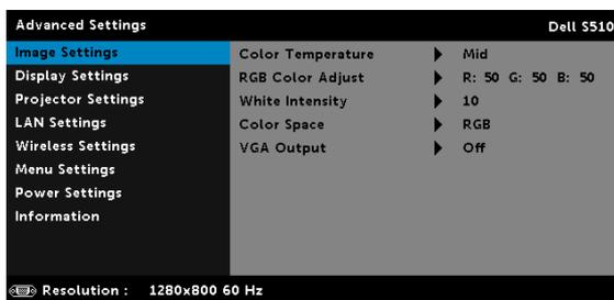
**COLOR TEMPERATURE (TEMPERATURA DA COR)**—Permite ajustar a temperatura da cor. A tela parece mais fria a temperaturas de cor mais altas, e mais quente a temperaturas de cor mais baixas. Ao ajustar os valores no menu **Color Adjust (Ajuste de cor)**, o modo Personalizado é ativado. Os valores são salvos no Custom mode (modo Personalizado).
