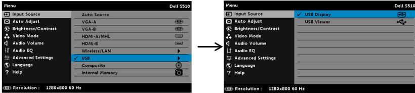
**USB DISPLAY (VISOR USB)**—Permite a você exibir a tela de computador/laptop para seu projetor através do cabo USB.
