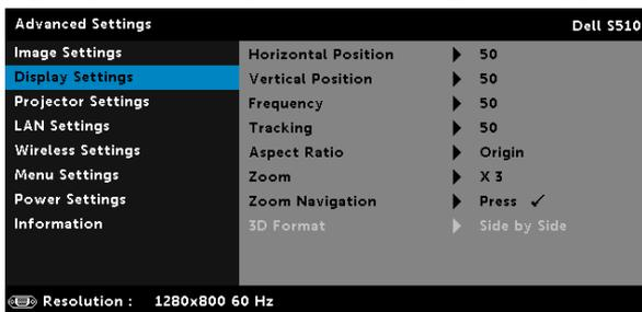
**HORIZONTAL POSITION (POSIÇÃO HORIZONTAL)**—Pressione  para mover a imagem para a direita e  para mover a imagem para a esquerda.
