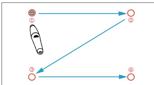
Toque na marca alvo na tela. (Pressione a tecla "ESC" para sair do processo de calibração). Após o 4º ponto de calibração ser concluído, por favor, aguarde 2 segundos, enquanto os dados de calibração são salvos.
