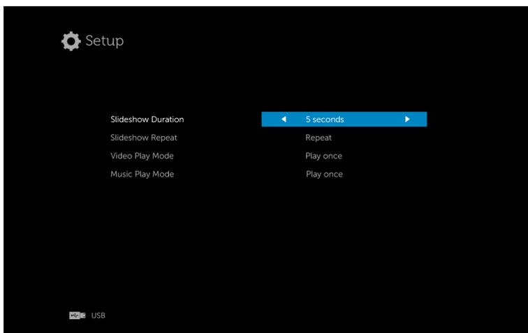
**SLIDESHOW DURATION (DURAÇÃO DA APRESENTAÇÃO DE SLIDES)**—Pressione ◀ ou ▶ para selecionar o intervalo de exibição da apresentação de slides. A imagem será automaticamente alternada para a próxima foto após o intervalo. As opções são: 5 seconds (5 segundos), 10 seconds (10 segundos), 30 seconds (30 segundos) e 1 minute (1 minuto).
