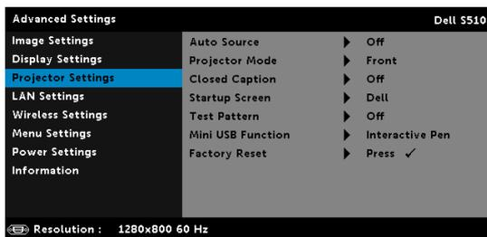
**AUTO SOURCE (ORIGEM AUTOMÁTICA)**—Selecione Off (Desligado) (o padrão) para travar o sinal de entrada atual. Se você pressionar o botão Source quando o modo Auto Source (Origem Automática) está ajustado em Off (Desligado), você pode selecionar manualmente o sinal de entrada. Selecione On (Ligado) para detectar automaticamente os sinais de entrada disponíveis. Se você pressionar o botão Source quando o projetor está ligado, este procura automaticamente a próxima entrada de sinal disponível.
